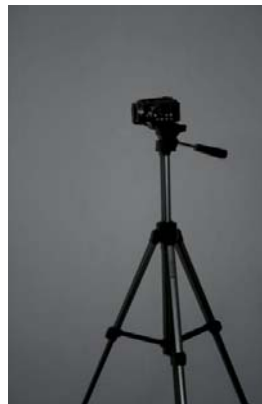
Figura 2.4.6.3. Trípode de fijación (b) y Video Digital JVC GZ-HD10 EVERIO (a)
